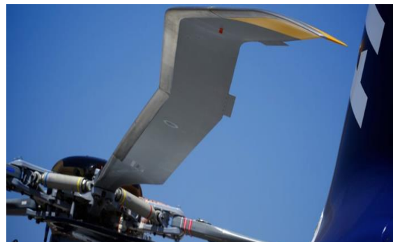
Blue Edge est une pale à la forme tout à fait singulière qui permet de réduire la signature sonore de l'hélicoptère tout en lui donnant une masse décollable plus importante (ONERA)
